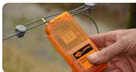
**Extra:** Il voltmetro digitale è uno strumento di monitoraggio indispensabile per misurare la tensione su il recinto. Il voltmetro è anche adatto per controllare il funzionamento della messa a terra e dell'energizzatore. Fate il Gallagher Check per un controllo completo della vostra recinzione.
