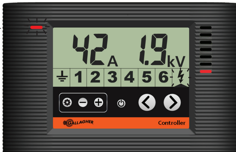
Il display mostra l'elettrofornice in allarme corrente
