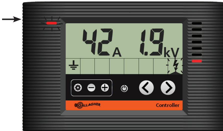
Controlador mostrando el Energizador con alarma de corriente
