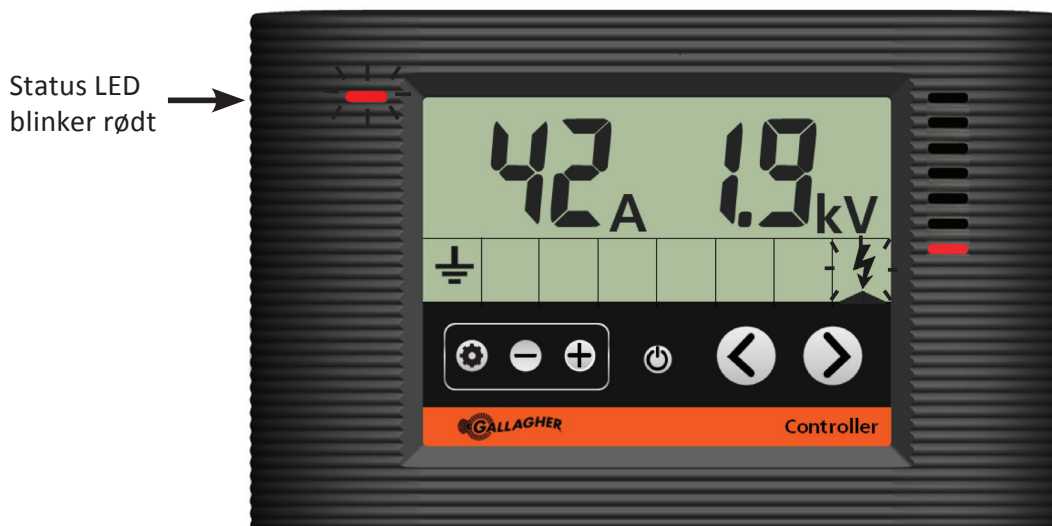
Styreenheden viser energizeren i strømstyrke alarm
