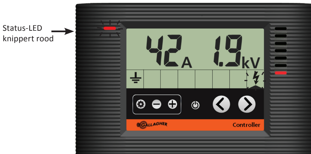
Bedieningspaneel toont het schrikdraadapparaat in stroomsterktealarm
