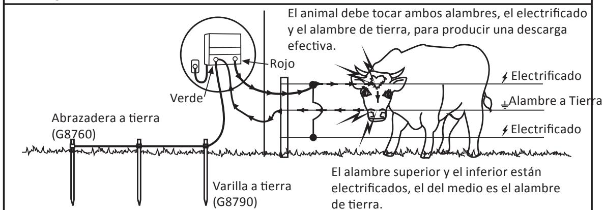
Las varillas de toma de tierra, de no menos de 2m (61/2 pies) de largo, deberán estar separadas a 3m (10pies) una de otra. Utilice un mínimo de 3 varillas de tierra para el M150, M300, M500.
