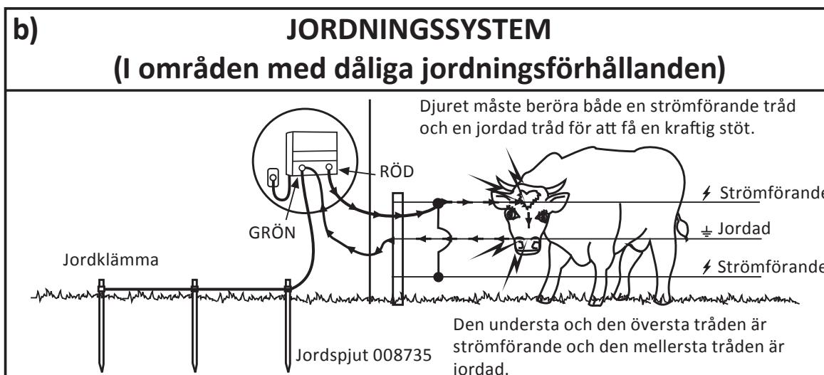
Minst en meter långa jordspjut bör fördelas med ett mellanrum på 3 meter. Använd ett minimum av 3 jordspjut till M150, M300, M500.
