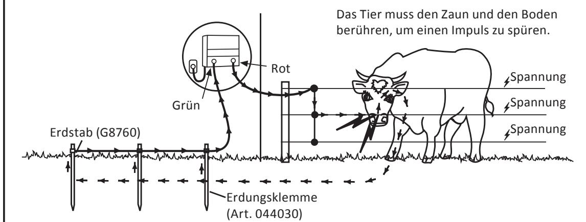
Die Erdstabs sollten mindestens 2 Meter lang sein, die Entfernung zwischen den Erdstaben sollte mindestens 3 Meter betragen. Verwenden Sie immer mindestens 3 Erdstabs für das M150, M300 und M500.
