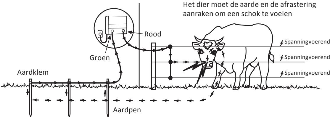
Aardingspennen, tenminste van 2 meter lang, moeten 3 meter van elkaar verwijderd in de grond geplaatst worden. Gebruik minimaal 3 aardingspennen voor de M150, M300, M500.
