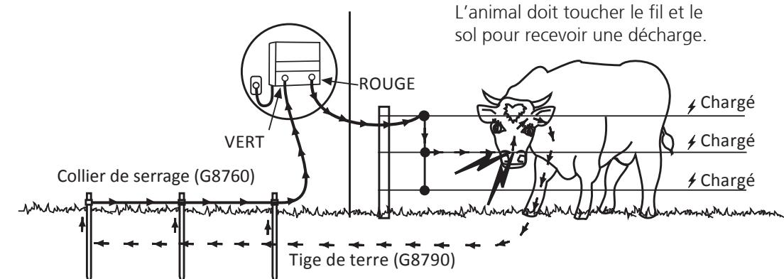
L'emplacement le plus efficace pour un système de mise à la terre est un sol constamment humide (voir illustration a).
