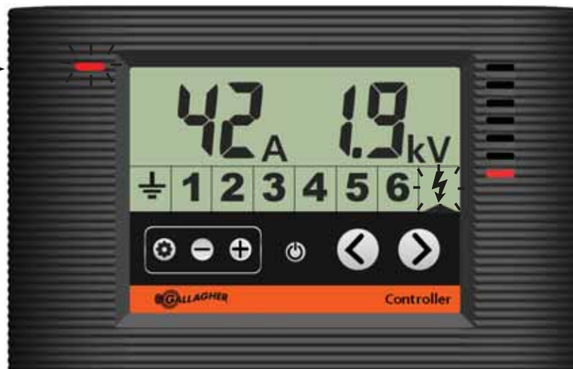
Contrôleur affichant une alarme Intensité sur l'électrificateur
