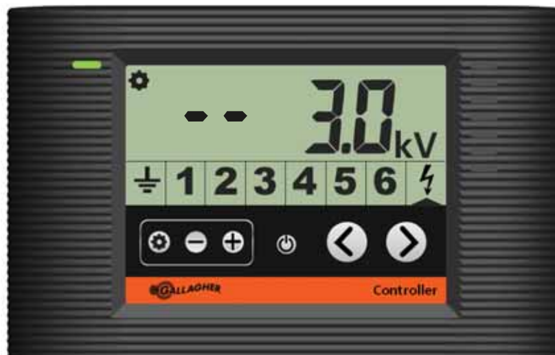
Contrôleur affichant le paramètre d'alarme par défaut pour l'électrificateur, avec désactivation de l'alarme Intensité et une tension à 3,0 KV
