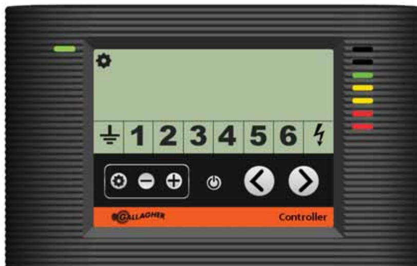
Kontrolleren viser udgangsspænding, der bliver justeret.
