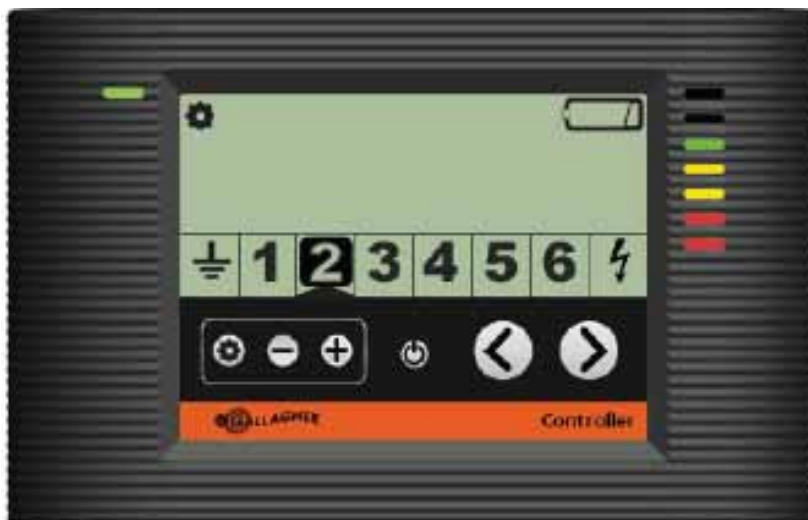
Controlador exibindo a zona 2 com bateria fraca
