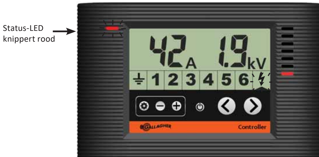
Bedieningspaneel toont het schrikdraadapparaat in stroomsterktealarm
