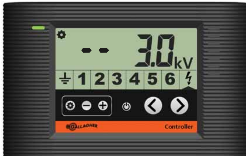
Il display mostra l'impostazione di fabbrica con l'allarme corrente disabilitato ed quello del voltage a 3.0KV
