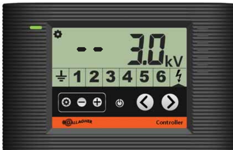
Controlador mostrando la alarma preestablecida por defecto con la corriente desactivada y voltaje a 3.0 kV
