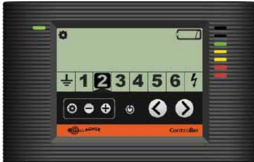
Styreenheden viser zone 2 med et lavt batteri
