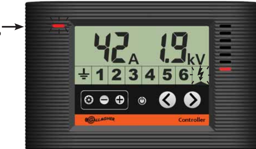
Il display mostra l'elettroficatore in allarme corrente
