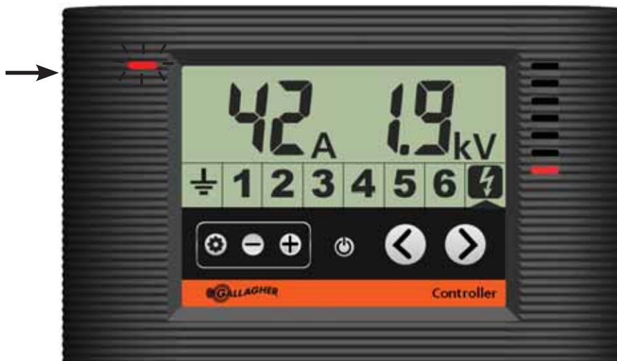
Kontrolleren viser, at spændingsgiveren har udløst en udgangsalarm
