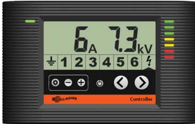
Controlador mostrando que el Energizador funciona normalmente
