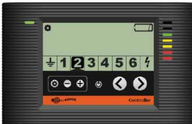
Controlador mostrando la zona 2 con batería baja
