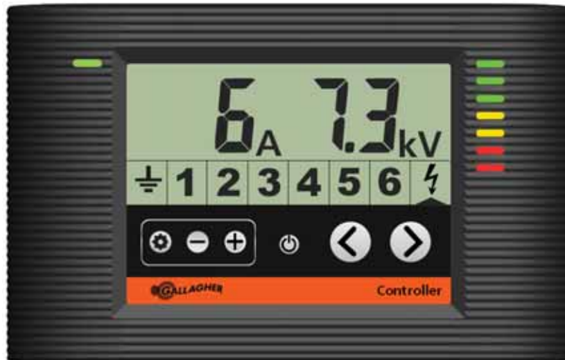
Kontrolleren viser, at spændingsgiveren fungerer normalt
