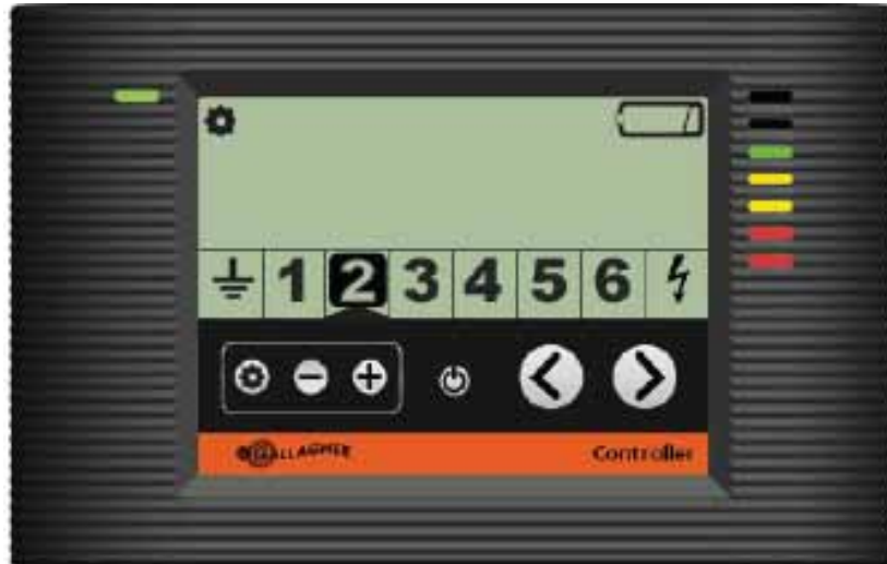
Kontroll visar zon 2 med en låg batterinivå
