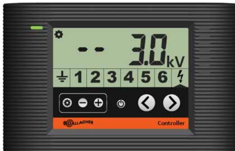
Controlador mostrando a configuração de alarme do energizador padrão com corrente desabilitada e tensão em 3.0 kV
