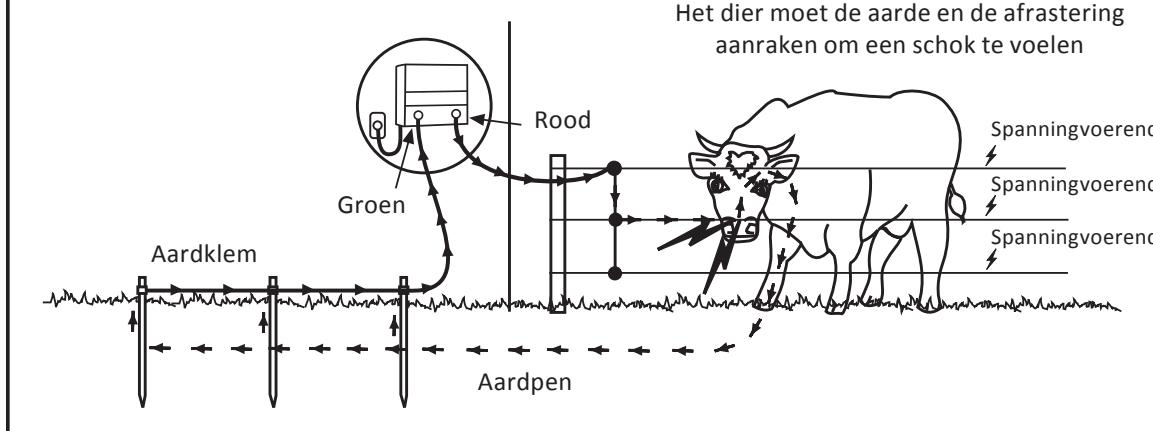
Aardingspennen, tenminste van 2 meter lang, moeten 3 meter van elkaar verwijderd in de grond geplaatst worden. Gebruik minimaal 3 aardingspennen voor de M1000.
