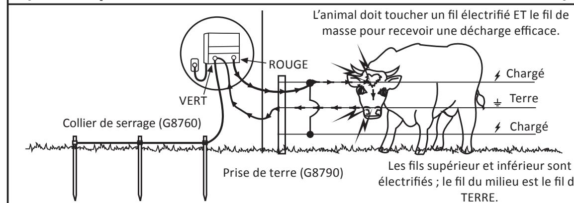
Des prises de terre, d'une longueur minimale de 2 mètres, doivent être enfoncées dans le sol avec un écartement d'au moins 3 mètres. Utilisez au minimum 3 tiges de terre pour le M1000.
