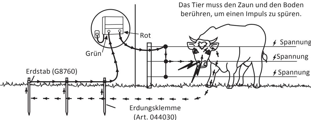
Die Erdstöcke sollten mindestens 2 Meter lang sein, die Entfernung zwischen den Erdstöcken sollte mindestens 3 Meter betragen. Verwenden Sie immer mindestens 3 Erdstöcke für das M1000.
