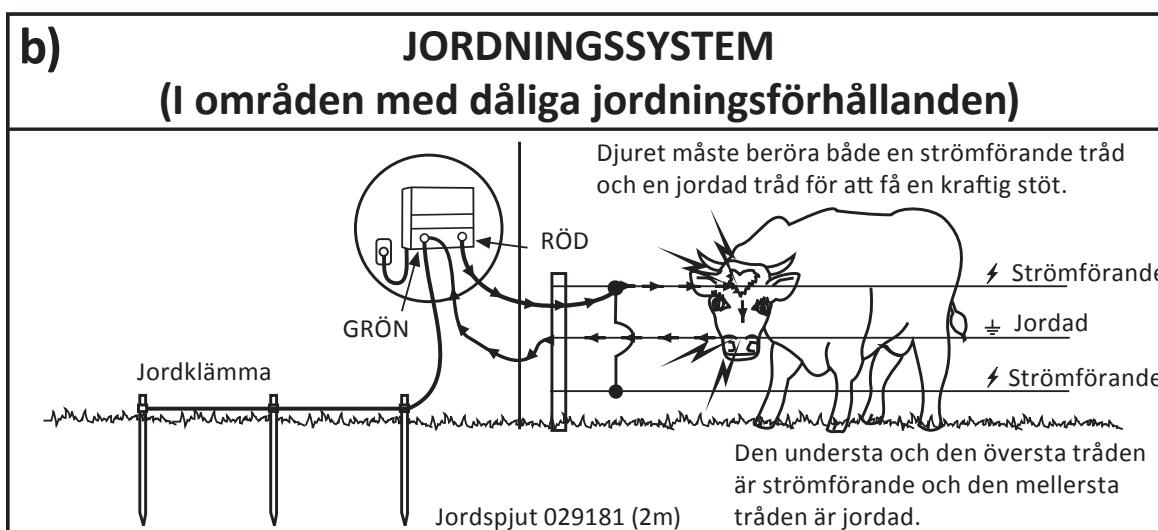
Minst en meter långa jordspjut bör fördelas med ett mellanrum på 3 meter. Använd ett minimum av 3 jordspjut till M1000.
