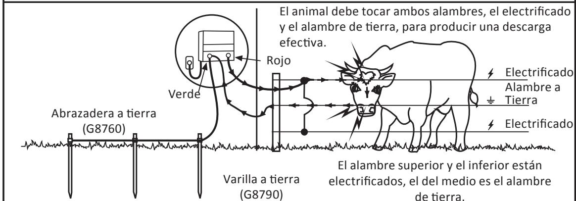
Las varillas de toma de tierra, de no menos de 2m (61/2 pies) de largo, deberán estar separadas a 3m (10pies) una de otra. Utilice un mínimo de 3 varillas de tierra para el M1000.
