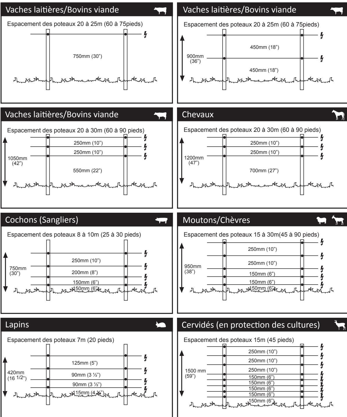
plat. Pour l'espacement des fils et des poteaux en zone sèche avec de mauvaises conditions de mise à la terre, consultez votre distributeur Gallagher.
