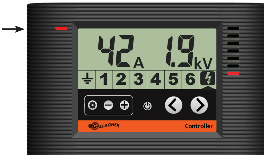
Kontrollenheten visar aggregatet i utgångslarm
