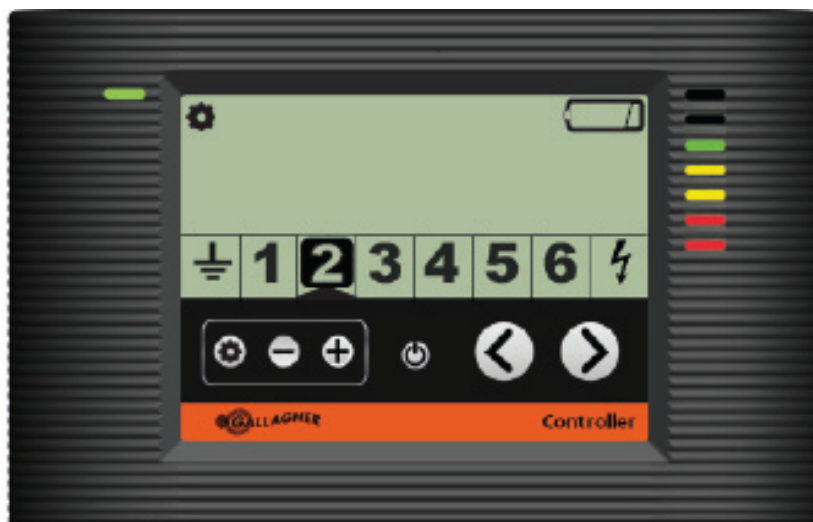
Styreenheden viser zone 2 med et lavt batteri
