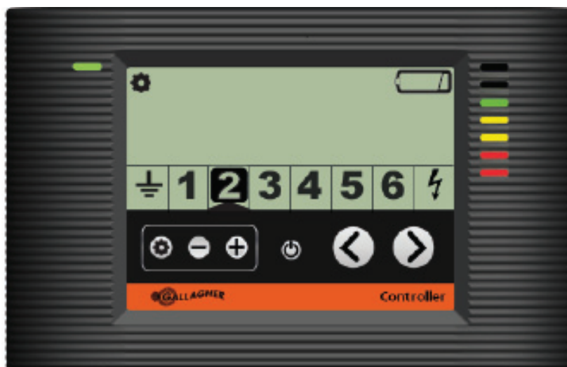
Controlador mostrando la zona 2 con batería baja
