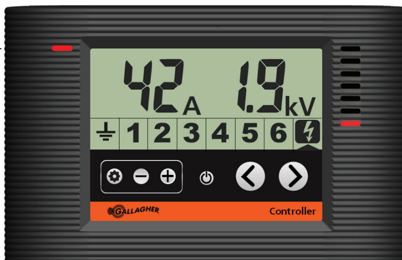
Contrôleur montrant l'électrificateur en état d'alarme
