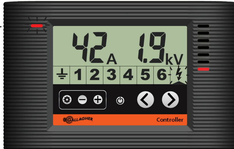
Contrôleur affichant une alarme Intensité sur l'électrificateur
